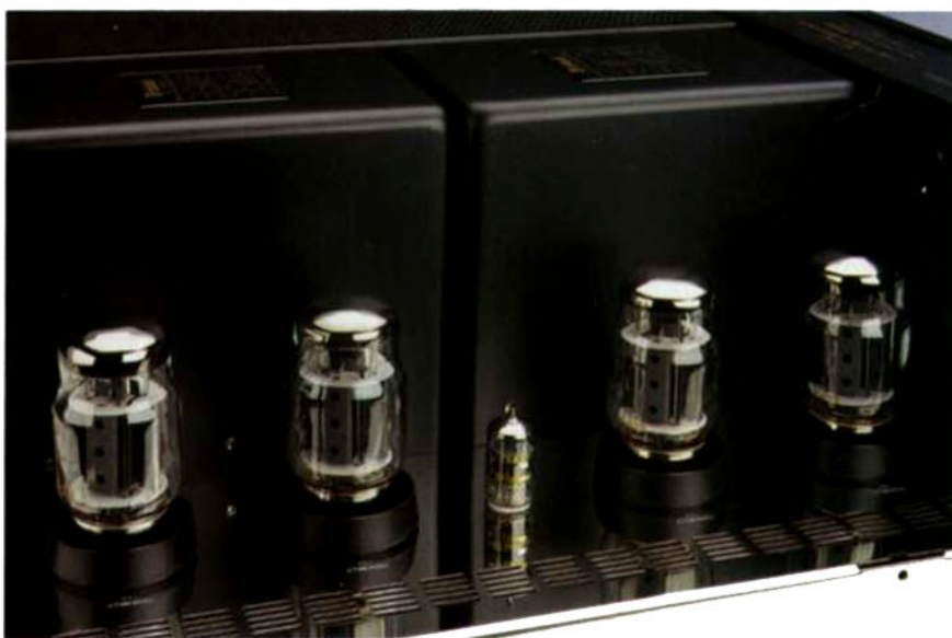
Ogni lato dell'amplificazione push-pull che costituisce il cuore di questo McIntosh dispone di un doppio triodo 12A7, con funzione di amplificatore di tensione, e quattro pentodi KT88, realizzati in Russia e ritagliati McIntosh.
