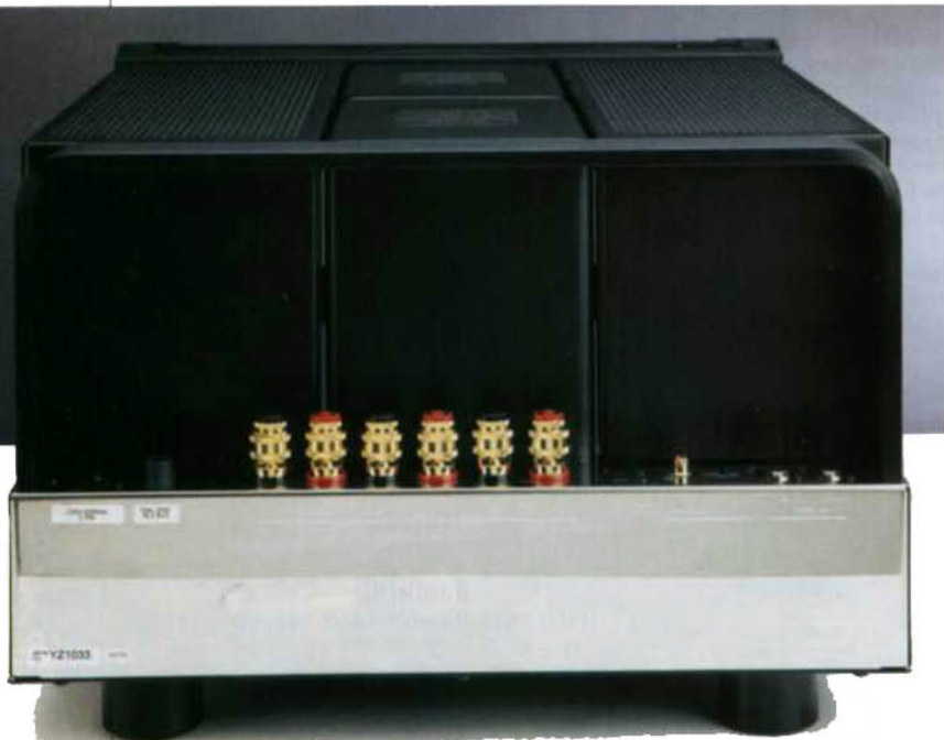
Il lato posteriore del 2301, con in bella evidenza la tripla dei morsetti di uscita, perfetti sia per serrare cavi di grande spessore che per qualsiasi altro tipo di terminazione. L'ingresso sbilanciato e bilanciato sono commutabili mediante un piccolo deviatore; per il bilanciato esiste anche una uscita sfruttabile, ad esempio, per il bi-amping.
